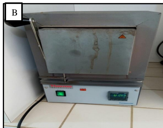
Figure 26 : Détermination de la matière organique. A : Echantillon incinéré ; B : Four à moufle
