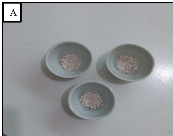
Figure 26 : Détermination de la matière organique. A : Echantillon incinéré ; B : Four à moufle
